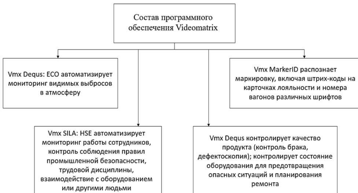
Рис. 2. Состав программного обеспечения Videomatrix
