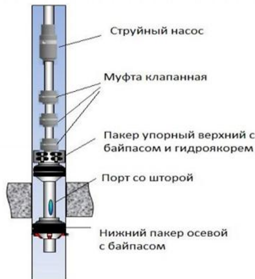
Рис. 5. Компоновка ГРП+струйный насос ДЖЕТ ПРО 89
