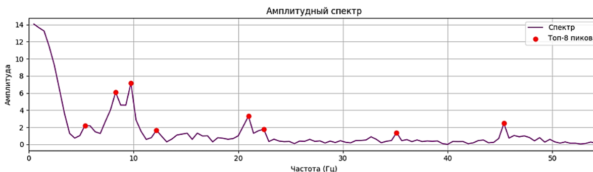
Рис.4 Разложение волны давления по показаниям датчика ДД2 в амплитудный спектр по частоте (Гц) [составлено автором]
