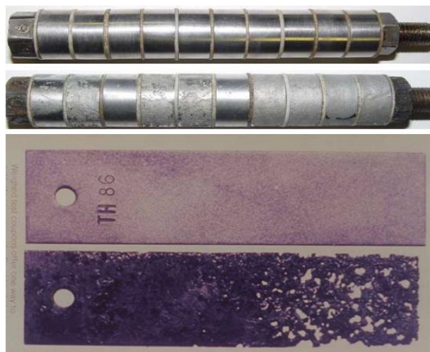
Рис. 1. Типичные образцы-свидетели до и после выдержки в агрессивной среде
