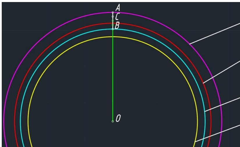
Рис. 1. Параметрические окружности зубчатого колеса с указанием характерных точек построений: 1 – окружность вершин зубьев; 2 – делительная окружность; 3 – основная окружность; 4 – окружность впадин
